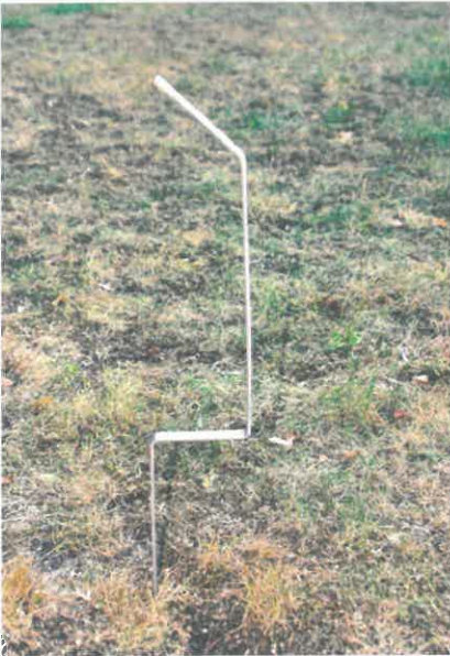
Haltepfosten, feuerverzinkt mit Spitze, senkrechte Länge 30 cm, Überhang 10 cm, Laufstraße 10 cm, Länge im Boden 35 cm. Support post, galvanized. Height 30 cm (vertical), plus 10 cm overhang. Walking path 10 cm. Depth in ground 35 cm.
