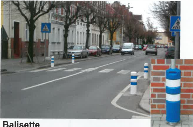
Balisette alternativ oder zusätzlich zum Leitzylinder an Fußgängerüberwegen
