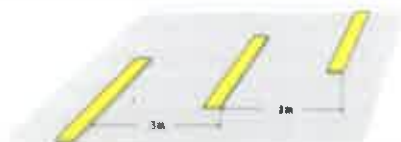
Anordnung von Warnschwelle auf dem Fahrstreifen alle 3 m
